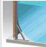
Grundstruktur aus Edelstahl und feuerverzinktem, epoxybeschichtetem Stahl
